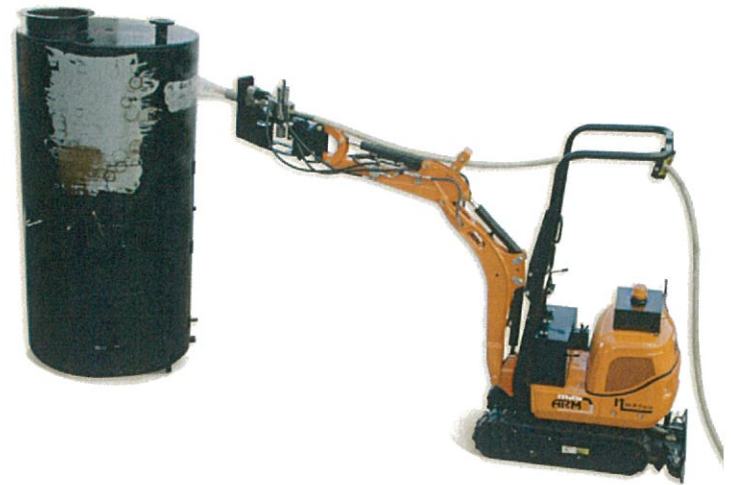
NLBの305ポンプとセットで使用する場合、MINI-ARMは最高2,800Barの圧力まで対応可能。
