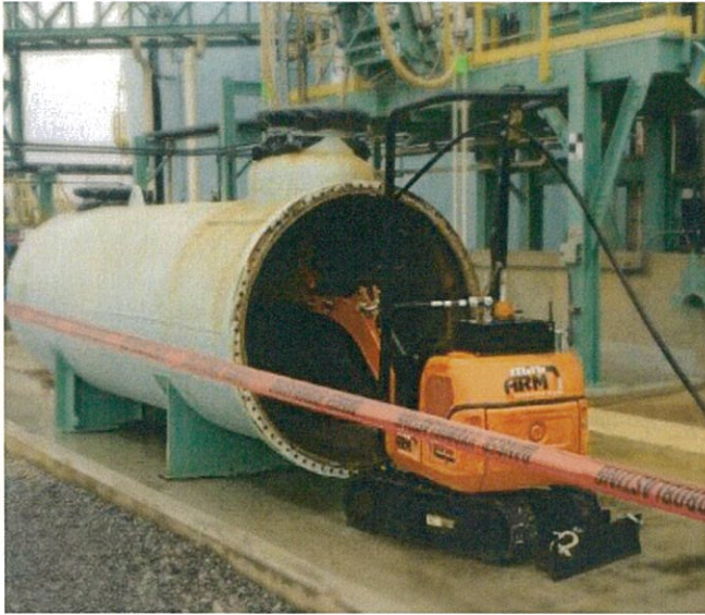
MINI-ARMは人が操作すると危険が発生しやすい狭い空間や特定区域での洗浄用に開発されました。
